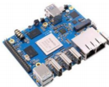
图 6-3 Orange Pi 5 Plus 主控制板
