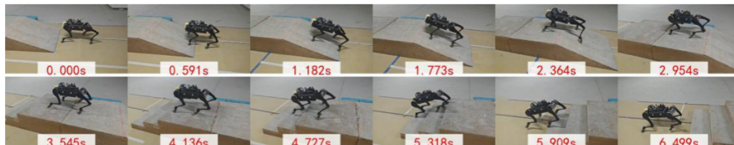
图 6-15 实机上斜坡下台阶实验
