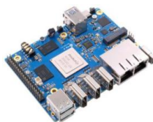
图 6-3 Orange Pi 5 Plus 主控制板
