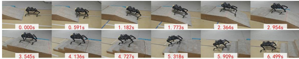
图 6-15 实机上斜坡下台阶实验
